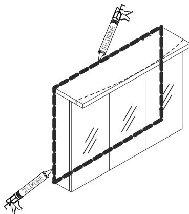
**S** Produkten är IP44 testad endast om den är installerad på en 100% rak och platt vägg. År din vägg inte rak kan tillverkaren inte garantera att ljusspeglar / spegelskåpet uppfyller IP44 norm. Därför rekommenderar vi att täta kanterna och utrymme mellan ljusspeglens / spegelskåpets ram och vägg med silikon. Det försäkrar en IP44 installation. Om en vattentät installation inte kan uppnås är spegeln av IP21 standard och kan installeras endast i zon 3. Se bilden i slutet av manualen.
